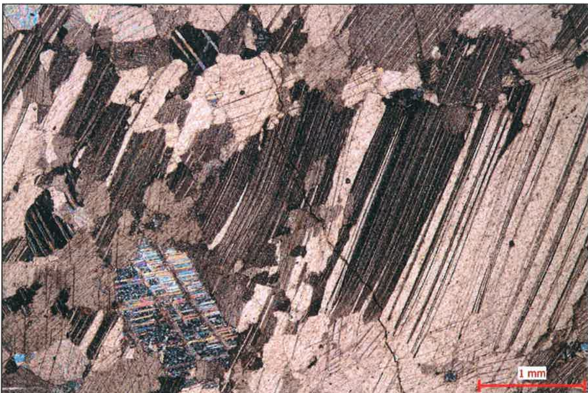
Foto 7. Středně zrnitý krystalický vápenec – mramor. XPL, zvětšení 40x. Hornina je prakticky výhradně složena z agregátu kalcitových, většinou zubovitě omezených zrn. Pouze mikroskopicky jsou patrné slabé projevy deformací. Tyto deformace jsou dobře patrné na zrnech kalcitů (prohýbání lamel–střed snímku). Další znaky deformace horniny dokládají chaoticky orientované, většinou neprůběžné mikropukliny, které jsou vyhojeny oxidy–hydroxidy Fe–Mn, popřípadě opakním rudním minerálem.
