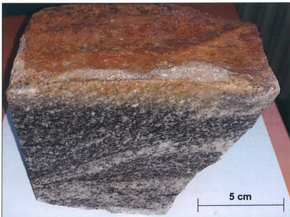
Foto 11. Makrofotografie odebraného vzorku lomového kamene z kamenolomu Krty – číslo vzorku 2. (surovina šedá). V omezení horninového vzorku je vyvinuta puklinová plocha, na které jsou vyvinuty prakticky souvislé povlaky oxidů–hydroxidů Fe–Mn. Podél této puklinové plochy dochází k zbarvení horniny (tvorba drobného lemu cca do 10 mm) do hnědých či rezavých odstínů.
