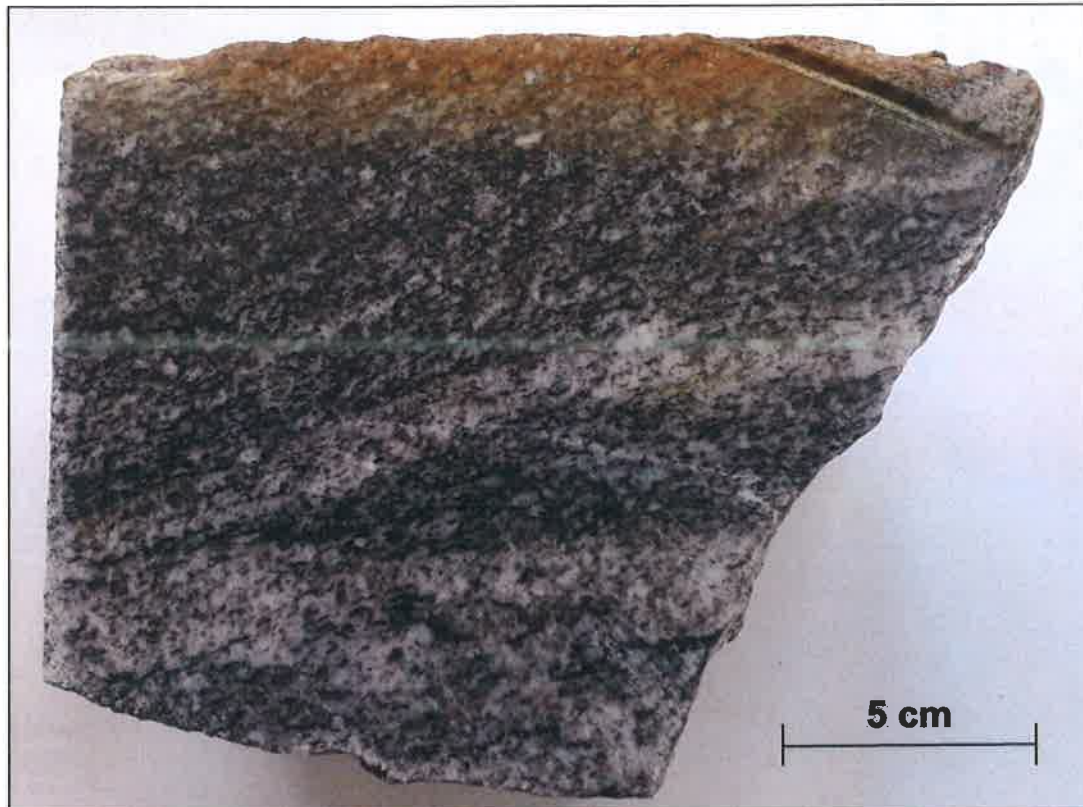
Foto 10. Makrofotografie odebraného vzorku lomového kamene z kamenolomu Krty – číslo vzorku 2. (surovina šedá). Odebraný vzorek má šedou, šedobílou, černě (hnědě) smouhovanou barvu. V rámci odebraného vzorku masivní a kompaktní stavby bez výraznějších diskontinuit (mikropuklin) a jiných významných deformačních struktur s plošně paralelní stavbou (foliací) se zrnito–šupinatou texturou horniny.
