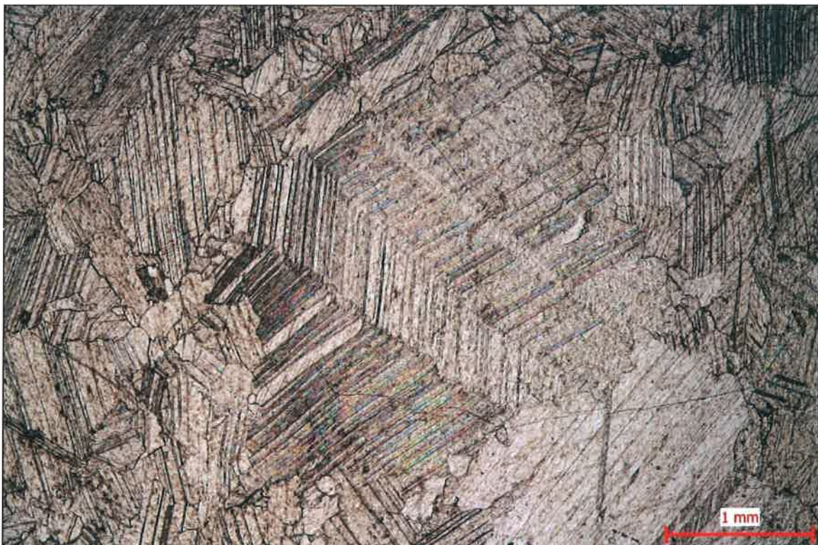
Foto 5. Středně zrnitý krystalický vápenec – mramor. PPL, zvětšení 40x. Hornina je prakticky výhradně složena z agregátu kalcitových, většinou zubovitě omezených zrn. Kalcit tvoří zubovitě (nevýrazně laločnatě) spjatá zrna, která jsou více či méně pigmentovaná (zakalená) oxidy–hydroxidy Fe–Mn. V hornině jsou běžně patrná lamelovaná nebo dvojčatně lamelovaná zrna. Lamely jsou u některých zrn tlakově deformované (mírné zprohýbání lamel).
